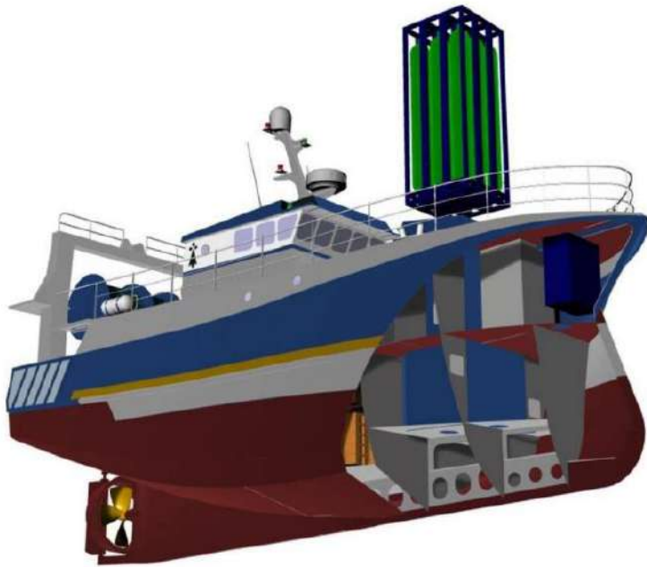
Projet Pilothy: chalutier de 17 m Piles à combustible
